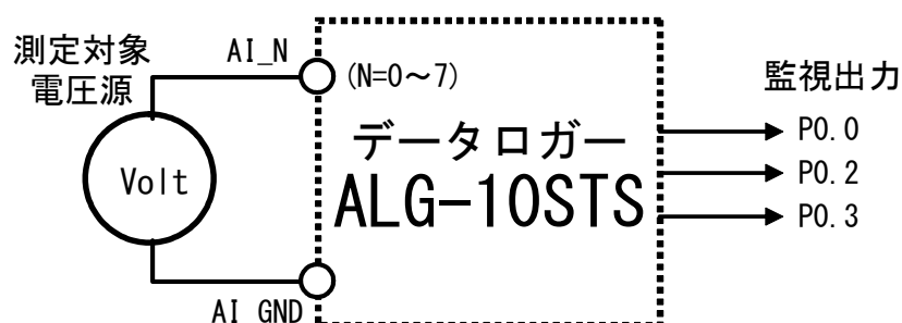
図 2.2 8 チャンネルシングルエンド入力と監視出力
