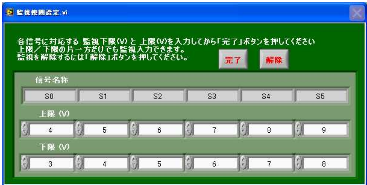
図 6-1 監視電圧範囲設定
