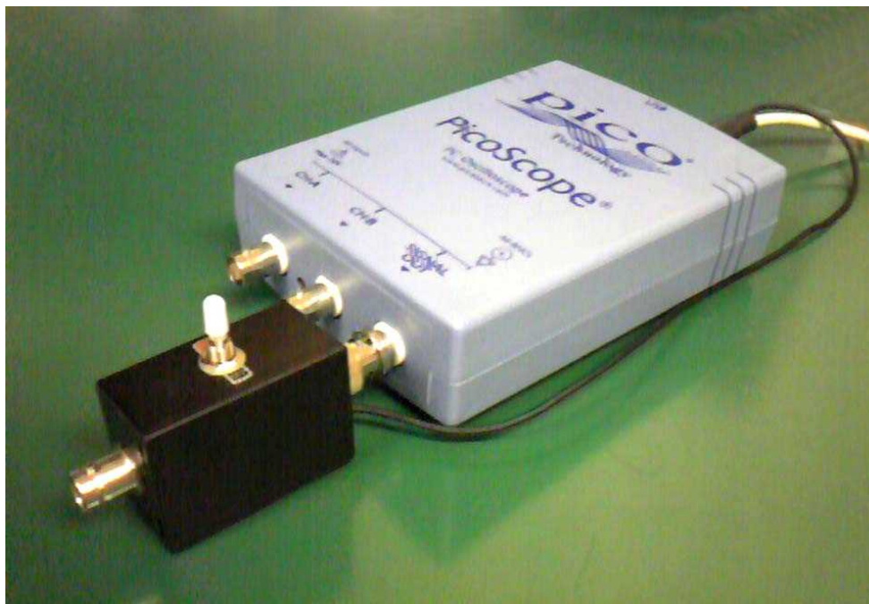
図 5.2 励起信号増幅器の接続方法
